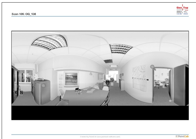
Scandokumentation planare 360°-Punktwolkenabwicklung 2D jedes Scanstandpunktes
