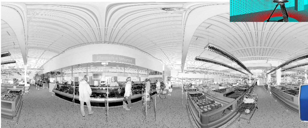
Planare 360°-Abwicklung eines Scans (3D-Punktwolke)
